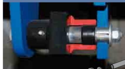
Все важные узлы крепления соединены болтами системы «ЛокПин». Принцип: Обычное соединение пальцами система „ЛокПин“. На конусные концы оси вставляются высококачественные втулки. С помощью болта втулки втягиваются, спрессовываются и фиксируются в кронштейне.
