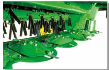
РЕЖУЩИЙ СТОЛ МОДУЛЬНОЙ КОНСТРУКЦИИ
