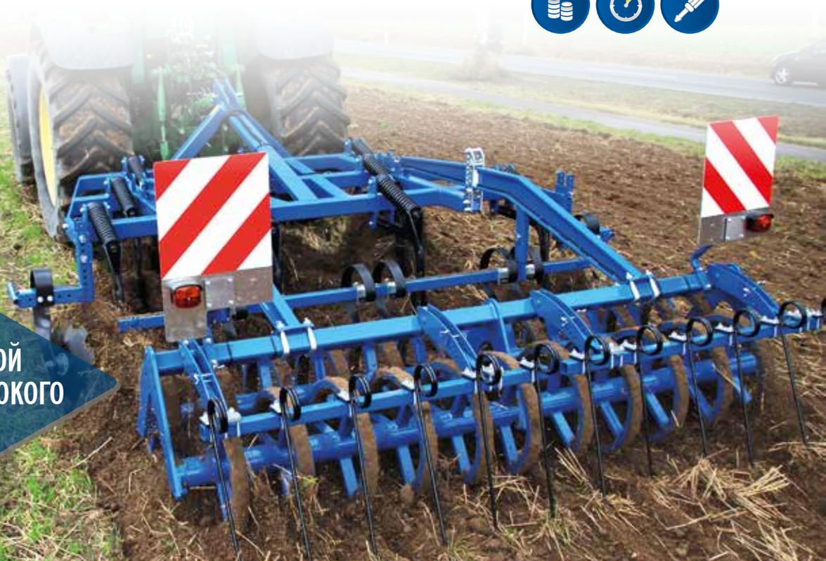
*TRIO* название данное нашему компактному 3-х рядному мульчирующему культиватору. Культиватор *TRIO* обладает широким спектром применения от мелкой пожнивной обработки до глубокого рыхления почвы.
