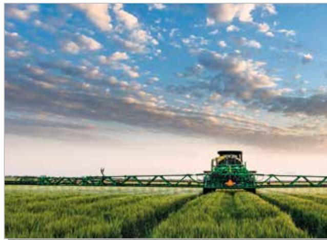
повышает производительность, так как штанга теперь может более точно поддерживать высоту опрыскивания урожая, выдавая точную норму опрыскивания. Качающаяся подвеска также отличается долговечностью, а дополнительная устойчивость означает меньшее повреждение урожая, а также снижаются механические повреждения штанги.
