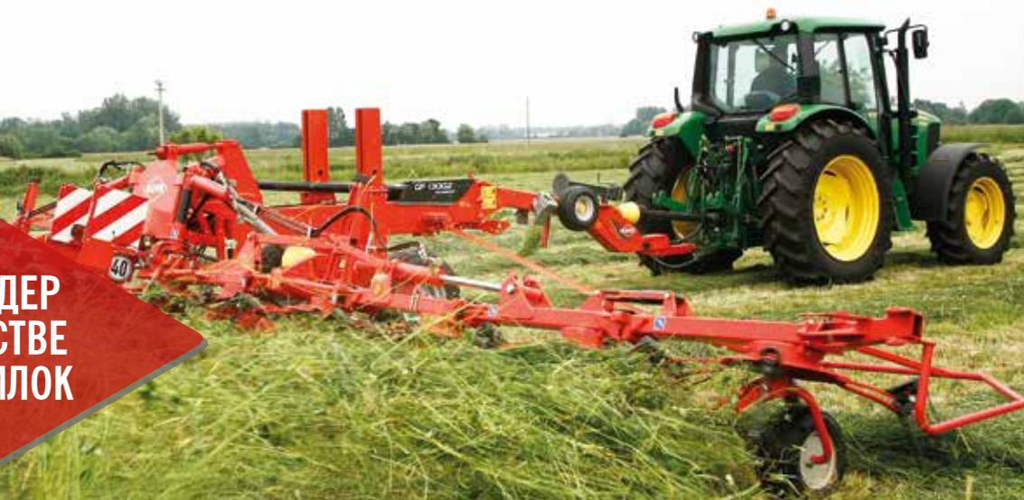
Ротор небольшого диаметра обеспечивает лучшее качество ворошения и сушки травы. Патентованная уникальная, не требующая обслуживания муфта *Digidrive* передает вращательное движение до 180°. Рабочая ширина ворошилок достигает 17,20 м, а транспортная - всего 2,40 м.
