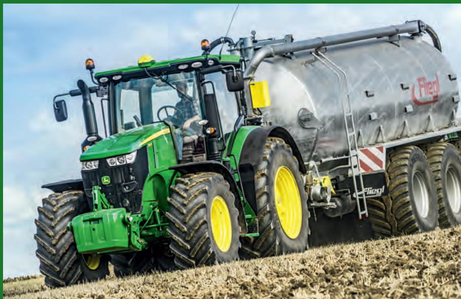
Kairėje: John Deere naujoji Manure Sensing sistema yrasvarbus žingsnis optimizuojant mėšlo paskleidimą ir maistinių medžiagų panaudojimą. Viršuje: Olandijos gamintojas „Vervet“ siūlo Manure Sensing taip pat ir savo savaeigiams skystojo mėšlo skleistuvams Hydro Trike
