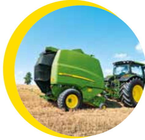
Susiformavus ritiniui, traktorių automatiškai sustoja pats ir presas apvynioja ritinį tinkleliu
