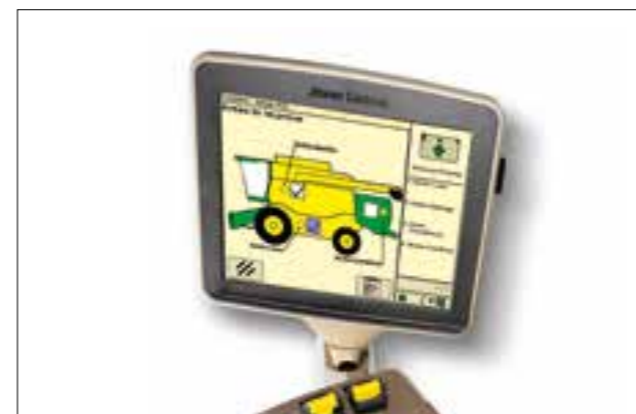
ICA – automatinė kombaino reguliavimo sistema
