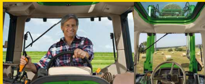
Papildus stiklotā jumta lūka sniedz vēl plašāku pārredzamību, it sevišķi zemās ēkās, atvieglojot darbu ar frontālo iekrāvēju – redzot kravu, ko parasti grūti saskatīt.
