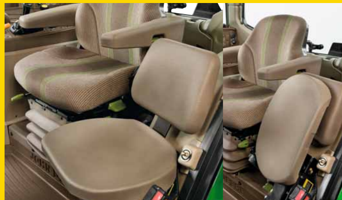
Papildus kabīnes sēdekli var naločīt, lai neaizšķērsotu izeju, kad tas netiek izmantots.
