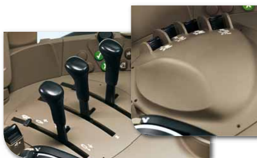
Izvēlieties M-SCV (pa kreisi) vai E-SCV (pa labi) hidroizvadu vadību. Abi vadības veidi nodrošina ātru darbību un precīzas aprīkojuma regulēšanas iespējas.
