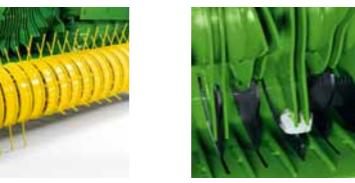
Pastāvīgi nemainīga smalcināšanas kvalitāte skābarības rituļiem. Smalcinātājnaži atrodas tuvu rotoram, lai būtu konstants smalcināšanas garums.
