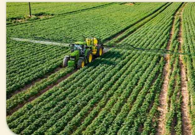
Sprayer Pro – automātiska miglošanas stieņa sekciju kontrole un automātiska galvenā vārsta aizvēršana lauka galos, tādējādi ietaupot vērtīgās augu aizsardzības ķīmikālijas.
