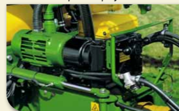
Ar dubultplūsmas sistēmu gaisa tiek sarāžots ar gaisa dzeses kompresoru, ko darbina traktors no jūgvārpstas ar pārnesumkārbas palīdzību.
