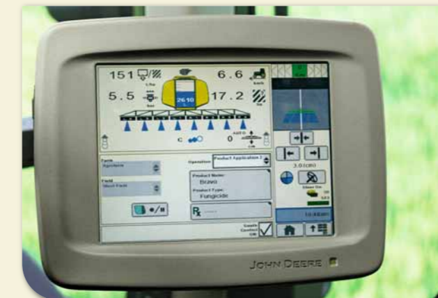
ISOBUS – agregātu vadība, kas atbilst ISOBUS sistēmai un darbu vadība, izmantojot tikai vienu monitoru. Nodrošina precīzu komunikāciju un kontroli starp agregātiem - pat ja tie ir ražoti dažādās rūpnīcās.
