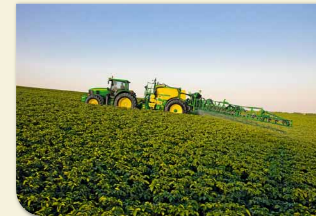
BoomTrac – automātiskā miglošanas stieņa sagāzuma un augstuma vadība, lai uzlabotu miglošanas izklādes precizitāti un varētu palielināt darba ātrumu uz lauka.
