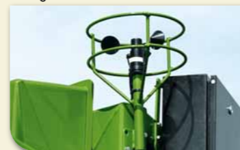
Ar uzmontēto vēja ātruma sensoru var noteikt reālo vēja ātrumu. Vadības iekārta ieteiks operatoram pareizo pilienu izmēru vai brīdinās par nepieciešamību pārtraukt miglošanu stiprā vēja dēļ.
