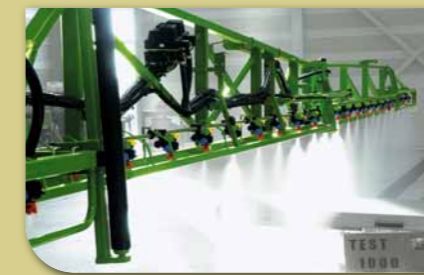
Visi John Deere miglotāji pirms tehnikas piegādes tiek vispusīgi pārbaudīti rūpnīcā. Šajā testā tiek mērītas izsmidzināšanas normas un sprauslu darbības kvalitāte visā smidzināšanas stieņa platumā, lai nodrošinātu visaugstāko precizitātes kvalitātes līmeni.
