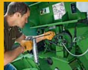
Centrālā eļļošana un automātiskā ķēžu eļļošana ļauj servisu veikt ātri un viegli.
