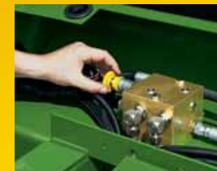
Rituļa blīvuma kontroles pogas pagriešana noregulē presi augu un mitruma izmaiņām.
