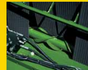
Smaga skābbarība? Nav problēmu. Tīrīšanas gliemežvārpsta uztur siksnas brīvas no netīrumiem.
