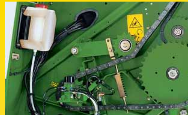
Papildus aprīkojuma automātisko eļļošanas sistēmu iespējams kontrolēt braukšanas laikā.
