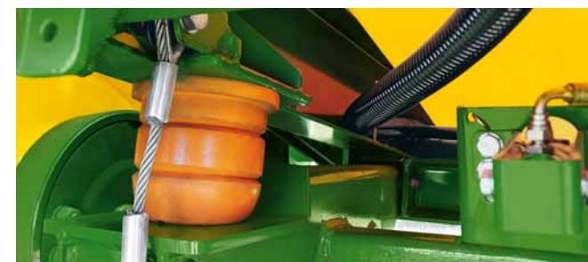
Papildus aprīkojuma dubultās atsaites tilta amortizācija nodrošina līdzsvaru, daudz precīzāku miglošanu un ātrāku transportēšanu.
