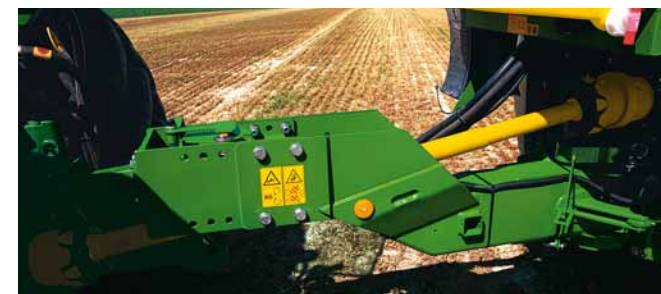
Šaurā stūrējošā dīstele neļauj tai saskarties ar traktora riteņiem
