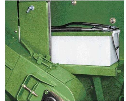
Masės išjungėjas ir akumuliatorius pasiekiami stovint ant žemės.
