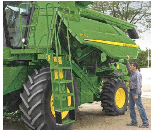
Dideli šoniniai gaubtai lengvai pasikelia, leisdami lengvai prieiti prie visų pagrindinių aptarnavimo taškų. Šoniniai gaubtai yra lengvesni ir tvirtesni už lakštinio metalo gaubtus ir atsparūs mechaniniams poveikiams.
