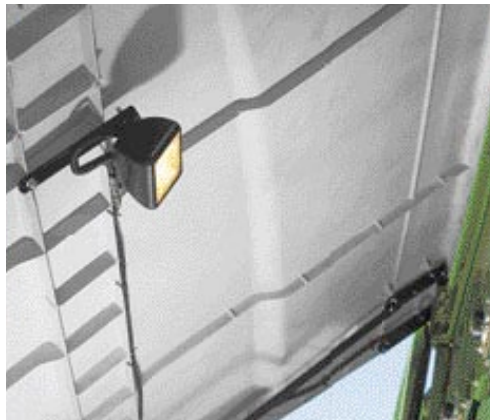
Daugybė techninio aptarnavimo lempų užtikrina geresnį matomumą, ieškant gedimų ir problemų bei atlikti techninį aptarnavimą naktį. Apšvietimo lempos: 2 lauko apšvietimo, 2 šoninės lempos, darbinės šviesos grūdų bunkeryje bei ant iškrovimo sraigės, 2 valytuvo, transporto bei šoninės lempos, apšviečiančios išlipimo iš kabinos laiptelius, papildomai įrengiamos aptarnavimo lempos, variklio skyriaus lempos ir 6 didelio intensyvumo halogeninės infraraudonųjų spindulių lempos.
