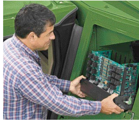
Vienintelė elektronikos dėžė užtikrina greitą ir lengvą diagnostiką.
