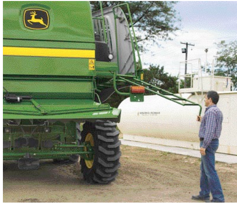
Ištraukiamais aptarnavimo laipteliais lengva ir patogų užlipti prie variklio. Viskas, ko reikia variklio aptarnavimui ar patikrinimui, yra tiesiai prieš jus.
