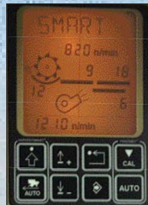
HarvestSmart sistemos nustatymai rodomi kabinos kampe esančiame ekrane.
