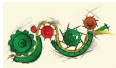
Tik pažvelgus į kūlimo-separavimo sistemos schemą, galima įsitikinti, kad ten nėra staigių kampų, kurie drastiškai pakeistų judančios javų masės judėjimo kampą.
