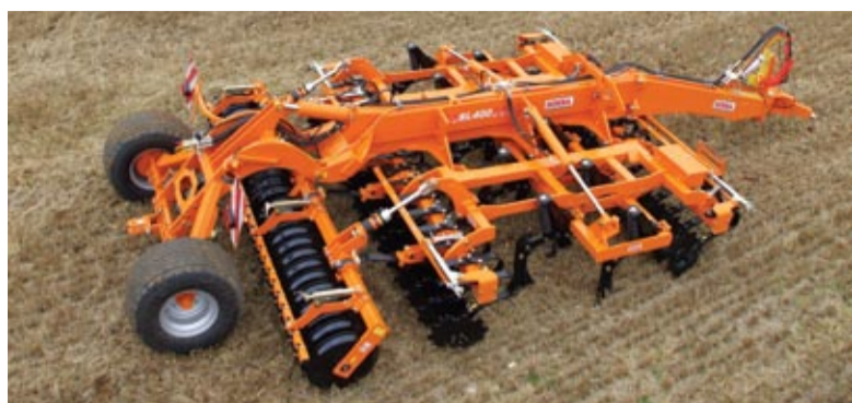
Lietuvos ūkiams labiau tinkamesnis darbinų sekcijų išdėstymo variantas yra: diskai, nagai, diskai (DND) ir volas.
