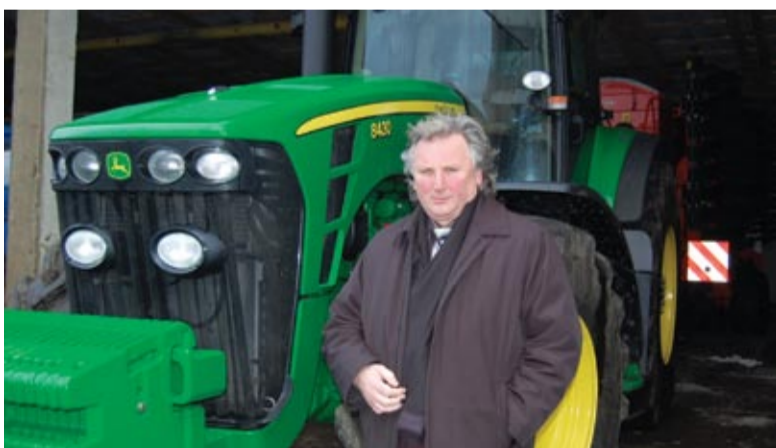
Ūkininko R. Počobuto įsigytam John Deere 8430 300 AG traktoriui su protinga galios valdymo sistema pataukti 6 m. pločio ar 8 korpusų plūgą yra lengvai įveikiama užduotis.
