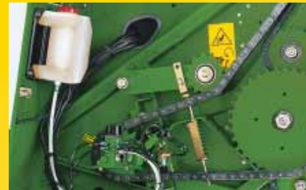
Pasirenkama automatinė tepimo sistema, valdoma mašinai judant.
