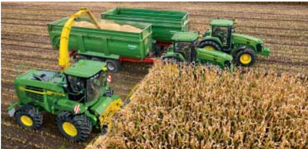
Dėka „protingos derliaus nuėmimo sistemos“ savybių, tokių kaip „smulkinimas iki bet kokio ilgio“ (angl. Variable Length of Cut (IVLOC)), mūsų savaeigės šienapjovės užtikrina pačią geriausią derliaus kokybę.
