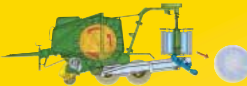
Transportavimo stalas pasisuka žemyn ir išmeta ritinį.
